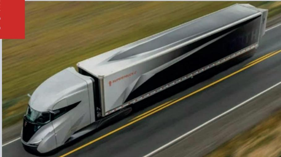
El Kenworth SúperTruck 2 se destaca, principalmente, por un perfil muy aerodinámico. Este camión se ha diseñado con una carrocería que reduce significativamente la resistencia al viento, algo transcendental si se quiere mejorar la eficiencia. Se presentó el pasado mes de mayo (2024) en ATC (Advanced Clean Transportation) de Las Vegas, Estados Unidos.
